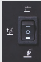
Три режими зварювання- MIG, STICK і LIFT/TIG
