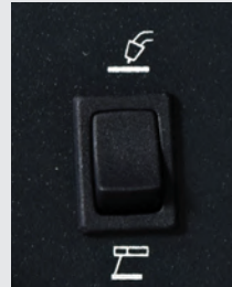
2 режими зварювання MIG/MAG і STICK (електродний)
