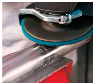
Шліфування зварних швів і видалення слідів на металі.
