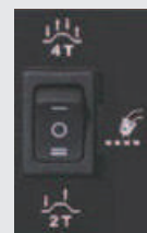
Зварювання в MIG режимі - 2, 4 такти та точкове зварювання
